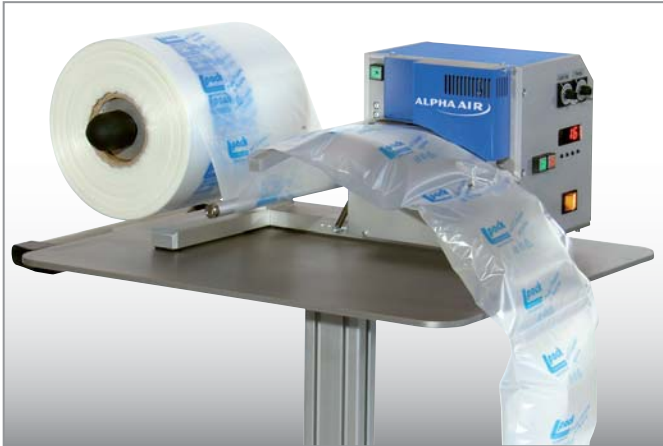
Beschickt mit bis zu 80 Luftpolstern pro Minute zwei Packplätze gleichzeitig
