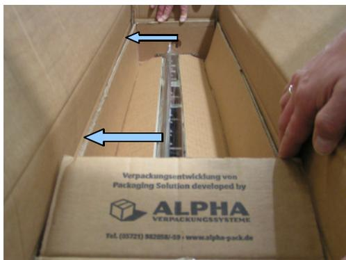
Da sich nun eine niedrigere Gesamthöhe ergibt konnte der Umkarton mit Hilfe vier kleiner Schnitte auf die neue Höhe angepasst werden. Die neu benötigten Knick-Kanten sind bereits am Umkarton vorhanden.
